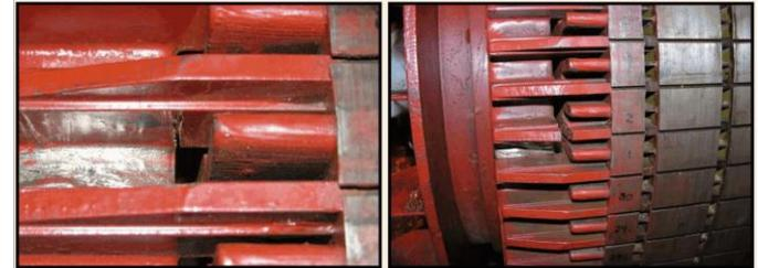
*Barra rota en el rotor de un motor de inducción*
